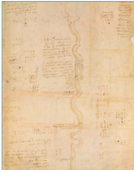
Figura 17 - Codice Atlantico, Planimetria di un tratto dell’Adda, che riporta anche il progetto del canale navigabile derivato dal fiume all’altezza di Brivio per superare le rapide dei Tre Corni
